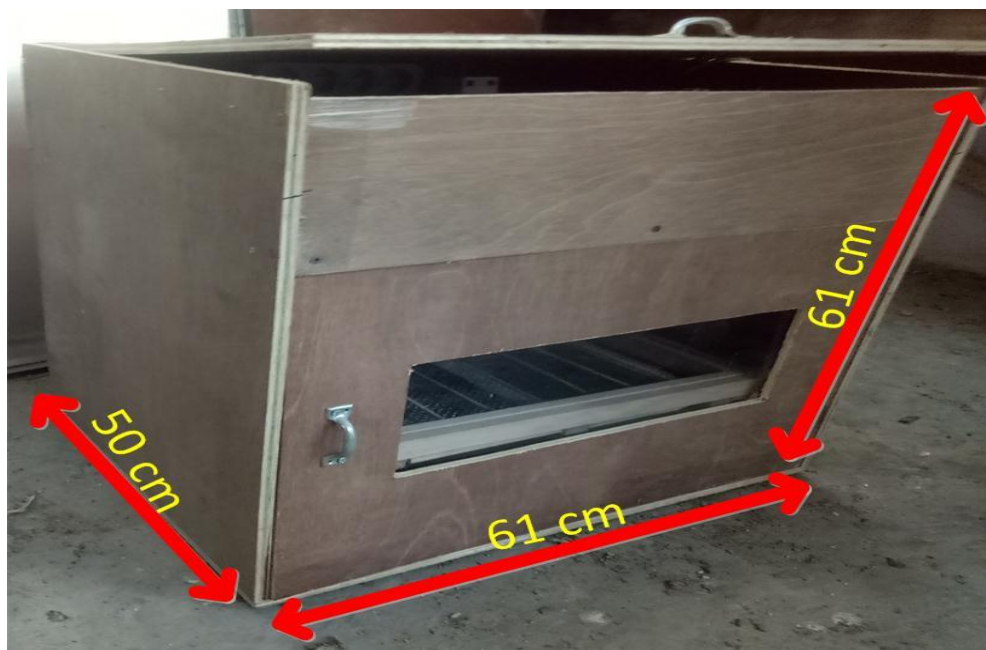
Gambar 4.1 Ukuran Mesin Penetas
