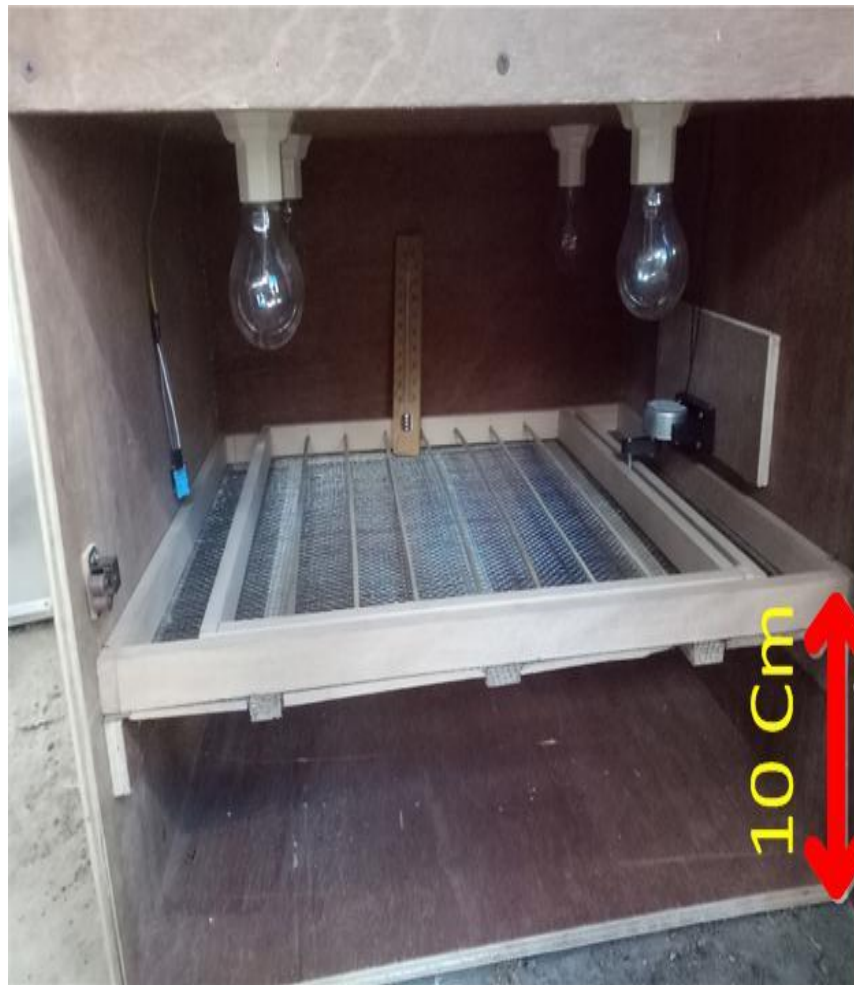
Gambar 4.2 Ukuran Jarak Rak Penetasan
