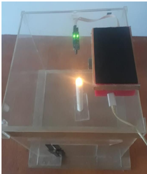
Gambar 4.6. Tampilan Pengujian Api pada Lilin
