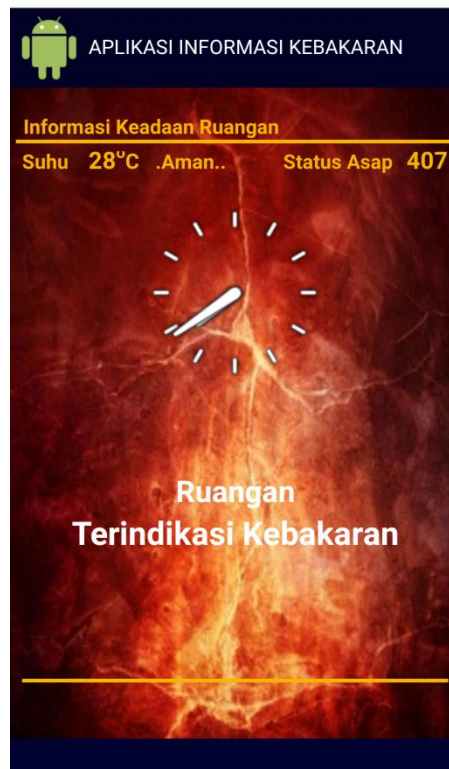
Gambar 4.5 Tampilan Aplikasi Android Pada Saat Sensor mendeteksi asap
